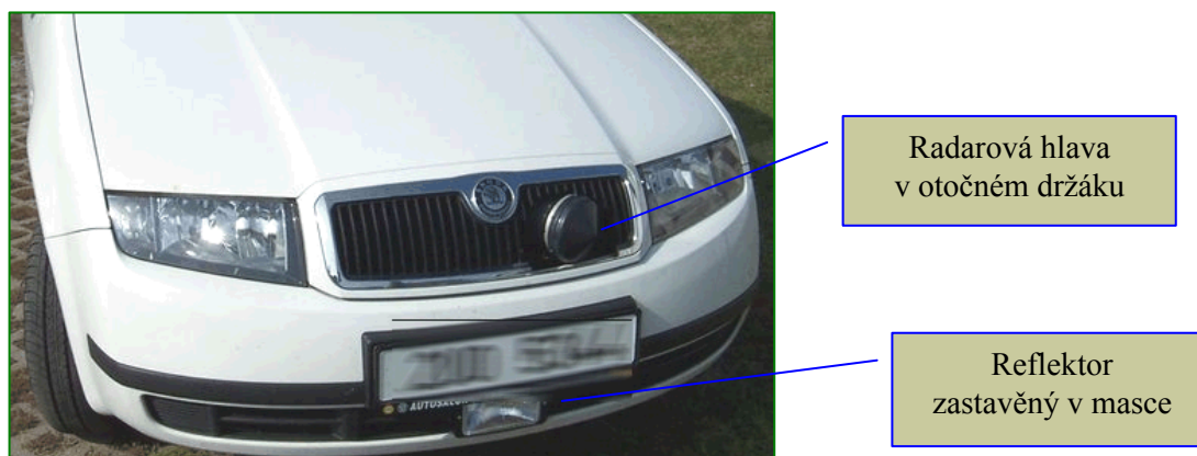
Obr. 32 Pohled na přední masku vozidla – ilustrační obr.
