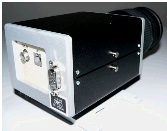
Obr. 18 Digitální kamera CCD GIGE s clonovou automatikou- vzor
