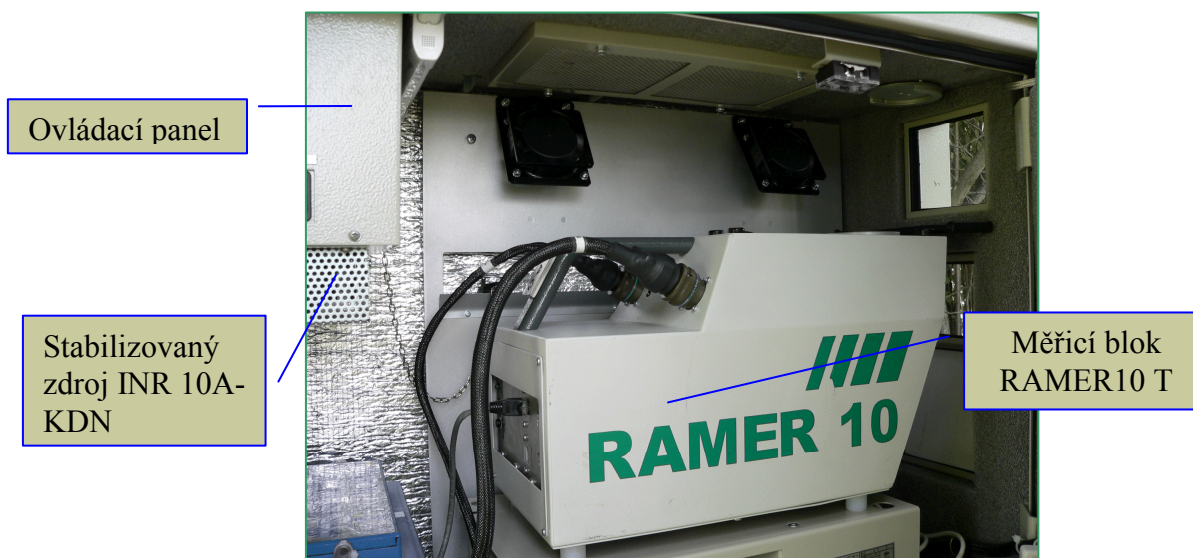
Obr. 40 Skříň RAMER10 P s radarovým měřičem
