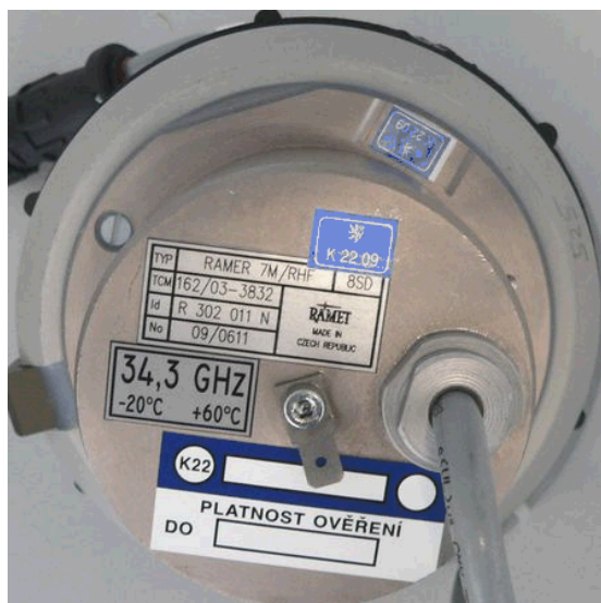
Obr. 148 Označení radarové hlavy
