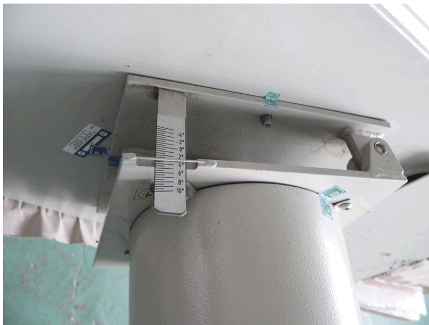
Obr. 142 Označení polohy naklápěcího mechanismu skříně RAMER10 P
