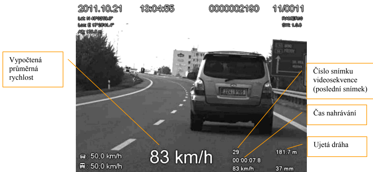
Obr. 83 Měření pomocí funkce Video
