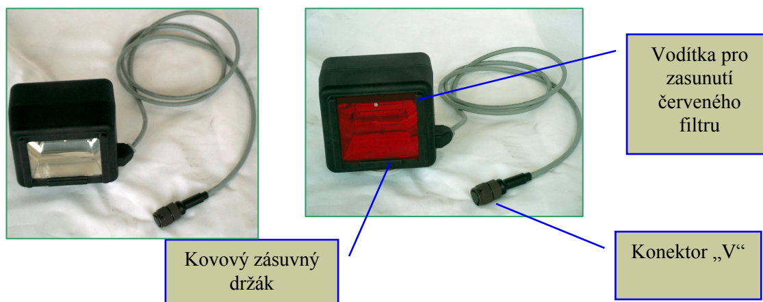
Obr. 19 Reflektor blesku bez filtru a s filtrem
