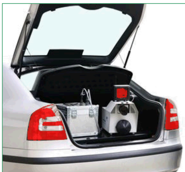
Obr. 61 Umístění RAMER10 T v kufru vozidla
