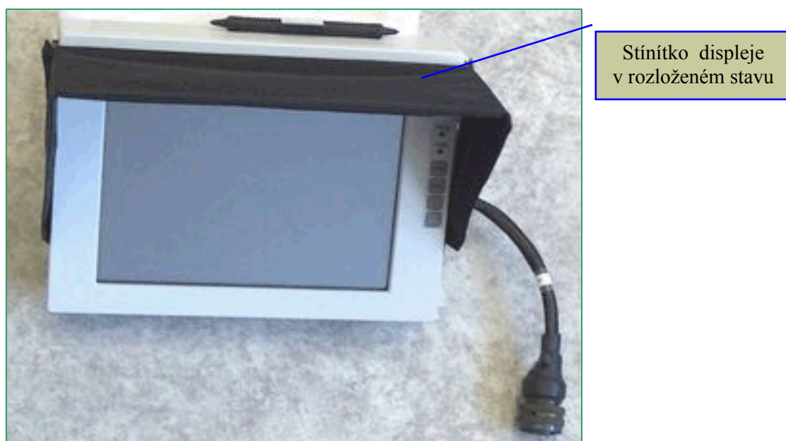
Obr. 15 Pohled na displej z přední strany se stínítkem v rozloženém stavu
