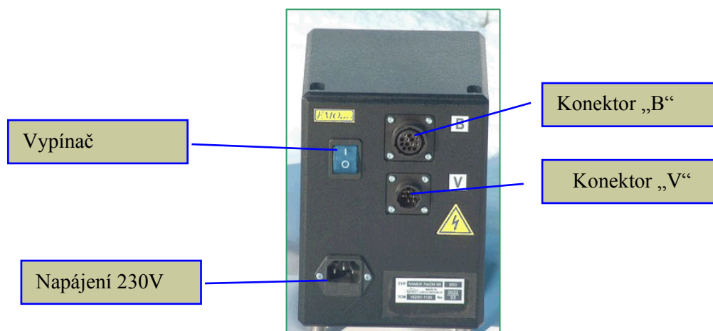
Obr. 24 Měnič blesku v provedení 230V
