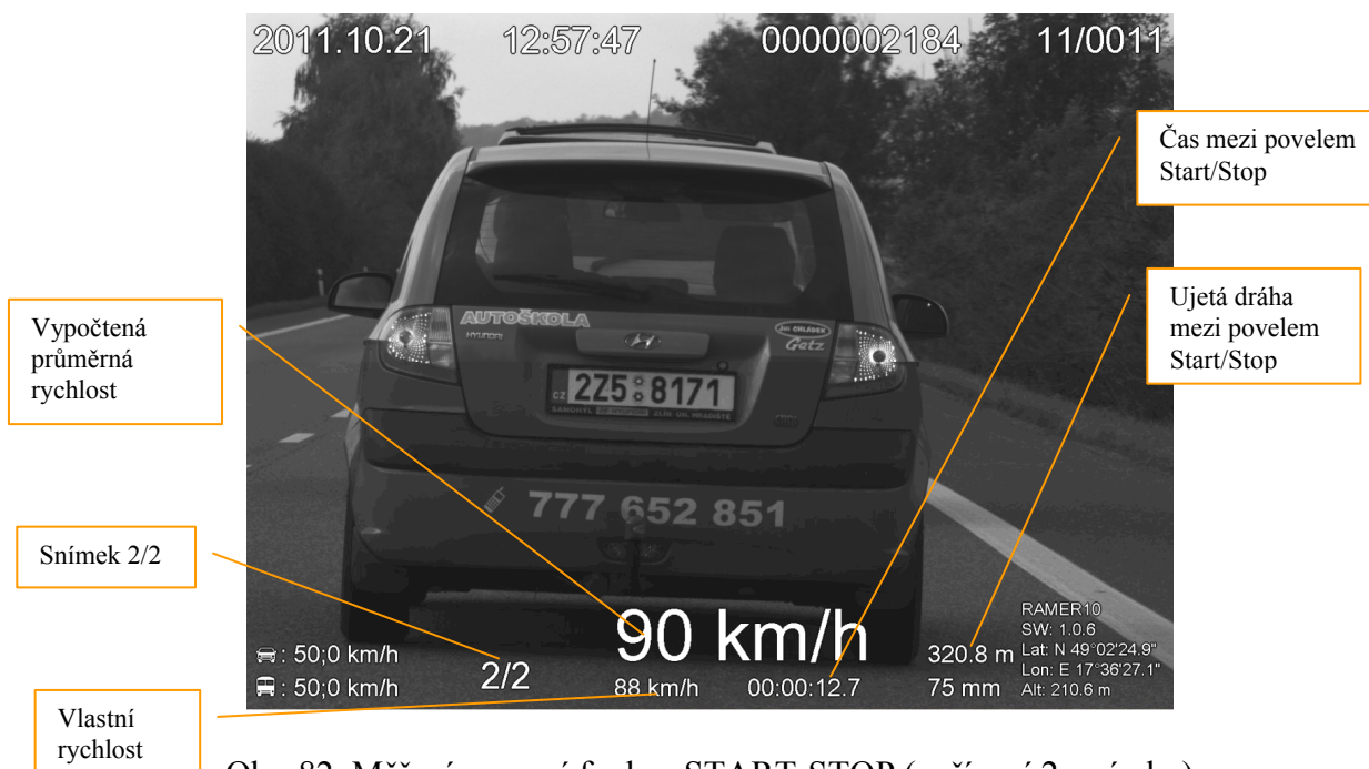
Obr. 82 Měření pomocí funkce START-STOP (pořízení 2. snímku)
