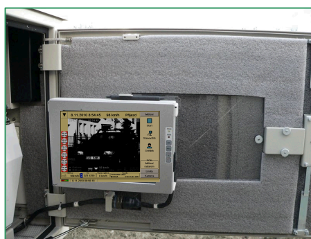
Obr. 75 Upevnění displeje na dveřích skříně RAMER10 P
