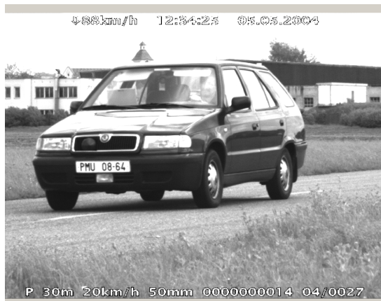
Obr. 88 Příklad snímku bez polariz. filtru
