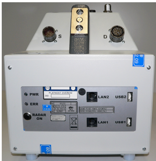
Obr. 140 Označení měřicího bloku RAMER10
