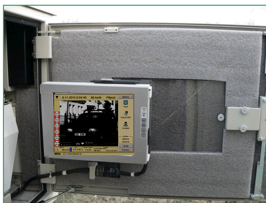
Obr. 42 Upevnění displeje na dveřích skříně RAMER10 P
